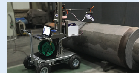
ロールの加工、熱処理の応力確認
